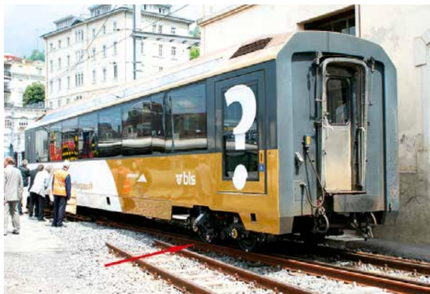
Der erste umgespurte BDs Golden Pass Panoramic Wagen am 18.5.2010 auf einem zweispurigen Gleisabschnitt der Versuchsumspuranlage von Montreux. Der Prototyp des Fahrgestells wurde in den technischen MOB Werkstätten Chermex montiert und eingebaut.
