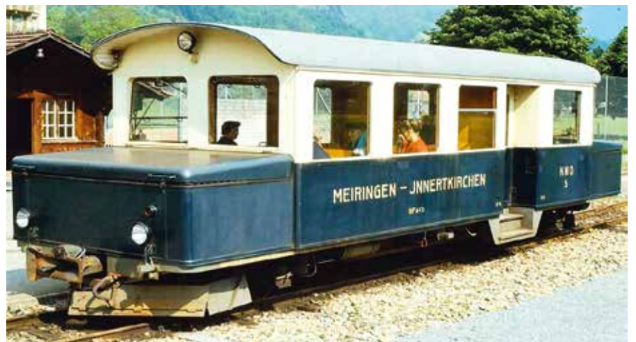
Der BFa 2/2 Nr.5 in 1974, und später als BDa 2/2 eingesetzte Akku Triebwagen, heute am Bahnhof Innertkirchen, und Nr.4 im Verkehrshaus Luzern ausgestellt. Beide Fahrzeuge mit Gleisproblem behaftet wegen der schweren Akkumulatoren an beiden Stirnseiten.
